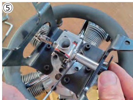
⑤外した時と逆の手順で、右側マウントとスロットル延長アダプタを装着して、完了です。 ⑤In the reverse sequence from ②, attach the right mount and throttle extension adapter. Now installation is completed.
