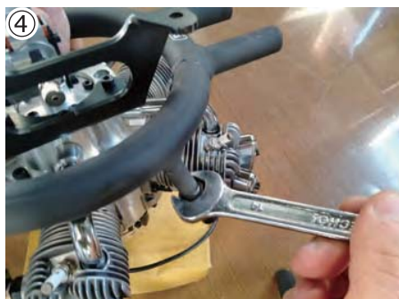
④スパナでリングマフラーのナットを締めこみます。5つを均等に対角線の順に徐々に締めこんで下さい。次に、同じくシリンダー側のアダプターナットをスパナで締め付けます。 ④Equally and gradually tighten up each nut of the ring muffler by spanner in a diagonal sequence. After that tighten adapter nuts for all cylinders in a diagonal sequence as well by spanner.
