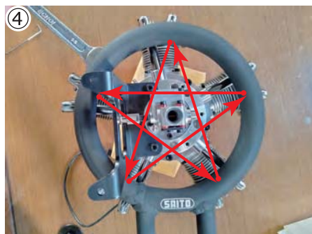
④スパナでリングマフラーのナットを締めこみます。5つを均等に対角線の順に徐々に締めこんで下さい。次に、同じくシリンダー側のアダプターナットをスパナで締め付けます。 ④Equally and gradually tighten up each nut of the ring muffler by spanner in a diagonal sequence. After that tighten adapter nuts for all cylinders in a diagonal sequence as well by spanner.
