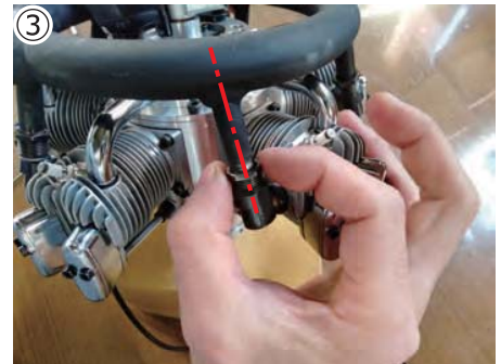
③リングマフラーナットを全てのアダプターに均等に軽くねじ込みます。ネジ部に潤滑油を少し付け、指で2～3山回るように位置を合わせて下さい。マフラーの各枝管とアダプターが出来るだけ同軸になる様に調整します。 ③Insert all the nuts of the ring muffler into each adapter. Apply lubricant oil to each thread and adjust position that all threads can be turned by your fingers for 2~3 turns. Keep in mind that the axes of the branch pipes and adapters should be aligned.
