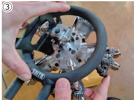
③リングマフラーナットを全てのアダプターに均等に軽くねじ込みます。ネジ部に潤滑油を少し付け、指で2～3山回るように位置を合わせて下さい。マフラーの各枝管とアダプターが出来るだけ同軸になる様に調整します。 ③Insert all the nuts of the ring muffler into each adapter. Apply lubricant oil to each thread and adjust position that all threads can be turned by your fingers for 2~3 turns. Keep in mind that the axes of the branch pipes and adapters should be aligned.
