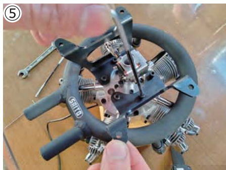
⑤外した時と逆の手順で、右側マウントとスロットル延長アダプタを装着して、完了です。 ⑤In the reverse sequence from ②, attach the right mount and throttle extension adapter. Now installation is completed.
