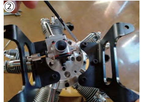
②スロットル延長アダプター、右側のマウントを外します。 ②Remove the throttle extension adapter and right mount.
