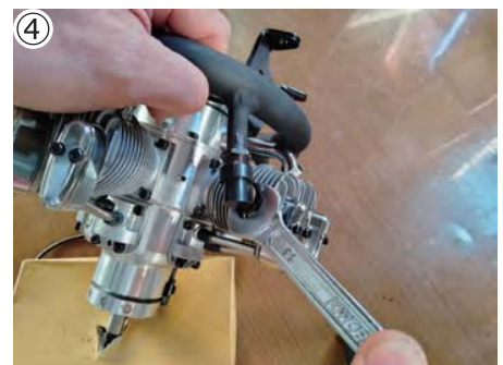
④スパナでリングマフラーのナットを締めこみます。5つを均等に対角線の順に徐々に締めこんで下さい。次に、同じくシリンダー側のアダプターナットをスパナで締め付けます。 ④Equally and gradually tighten up each nut of the ring muffler by spanner in a diagonal sequence. After that tighten adapter nuts for all cylinders in a diagonal sequence as well by spanner.
